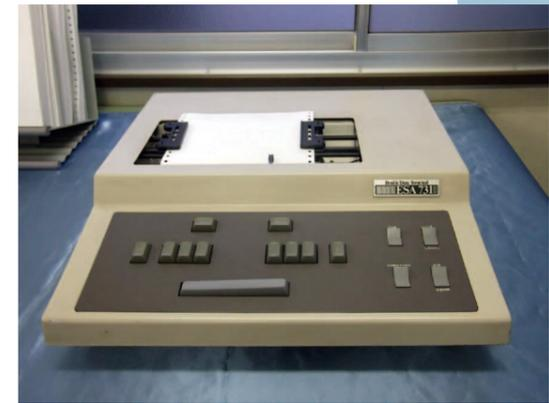
日本初のコンピュータ点字端末装置
