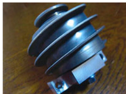
【ラセンローラー ASSY】 亜鉛ダイカスト/螺旋部後加工より 89%コストダウン
