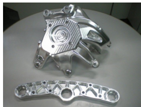
アルミブロックから削り出したロボット部品
