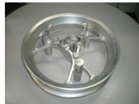
アルミ丸材から削り出したスクーターホイール
